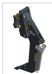
Asta con desarme automático y bocal doble de abono.
